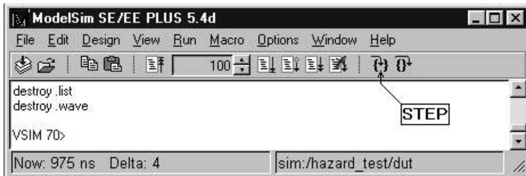
Figura 3.4: Butonul Step din fereastra principală a ModelSim .
